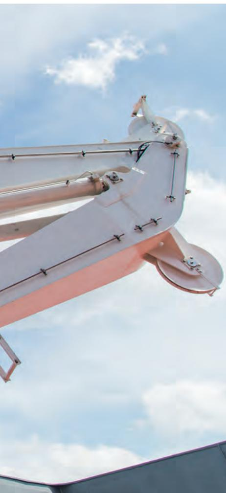
Два электрогидравлических крана со складной стрелой г/п 20 тн при вылете 13 м с системой активной компенсации вертикальной качки
